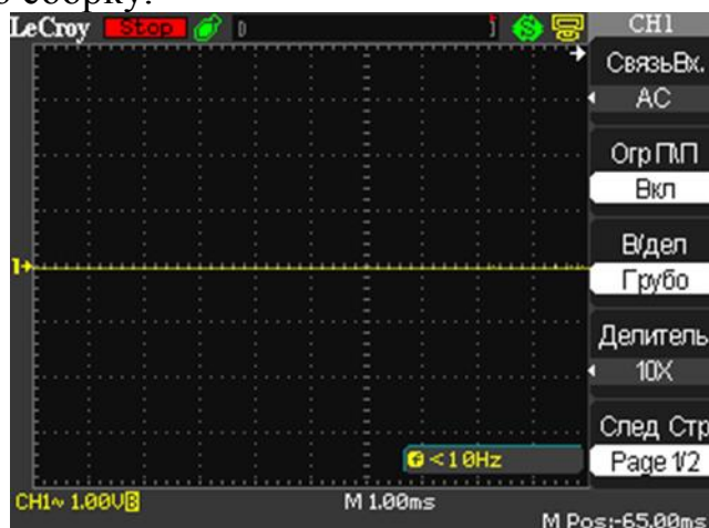
Рис. 2. Переменная составляющая тока через светодиоды
