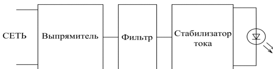
Рис. 3. Структурная схема источника питания для маломощных ламп
