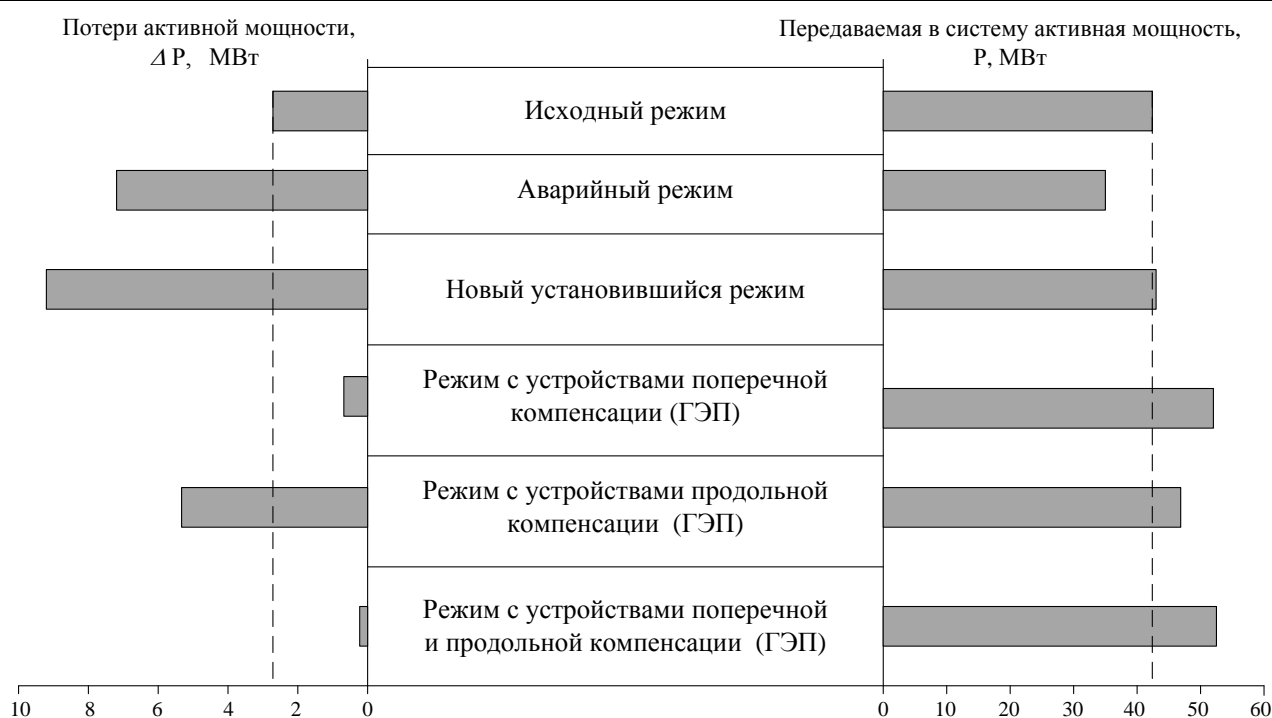
Рисунок 2 – Потери активной мощности и передаваемая в систему активная мощность для различных расчетных режимов
