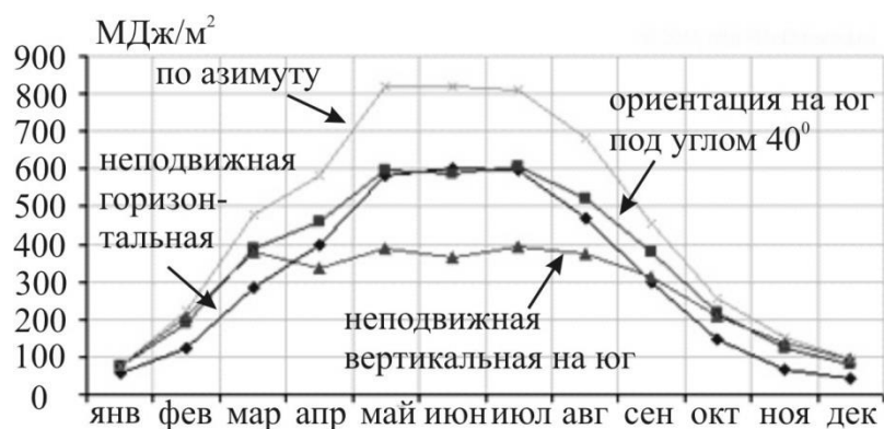
Рис. 1. Сезонная зависимость инсоляции от применяемых технологий ориентации панелей
