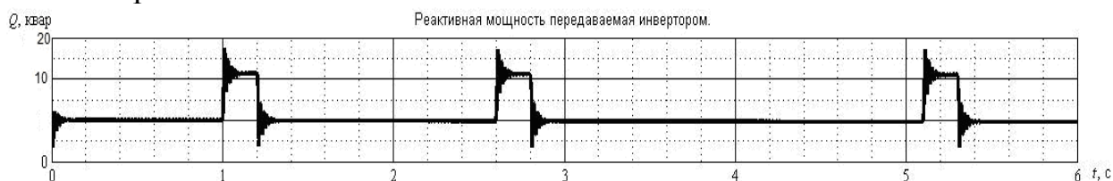
Рис. 3. Реактивная мощность, вырабатываемая АИН при провалах напряжения в сети электропитания.
