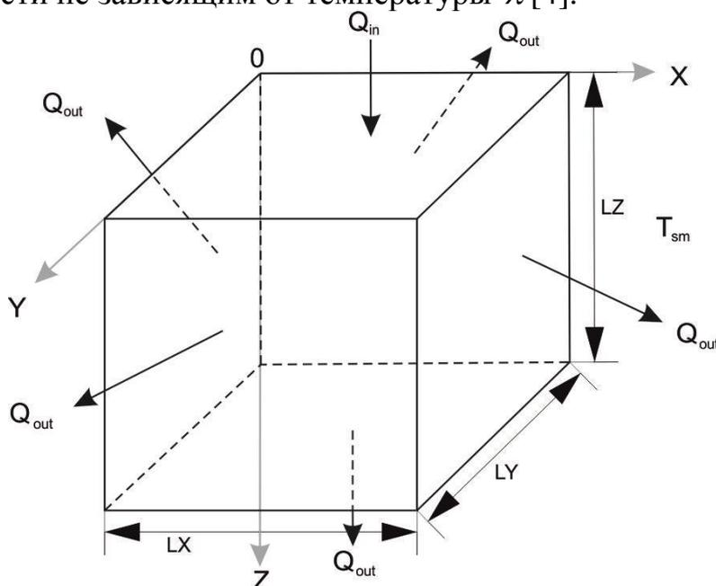
Рис. 1. Схема распределения тепловых потоков в образце.
