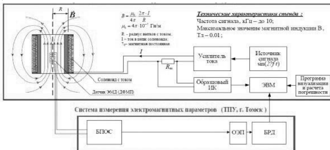
Рис. 2. Структурная схема стенда для испытания измерительных каналов
