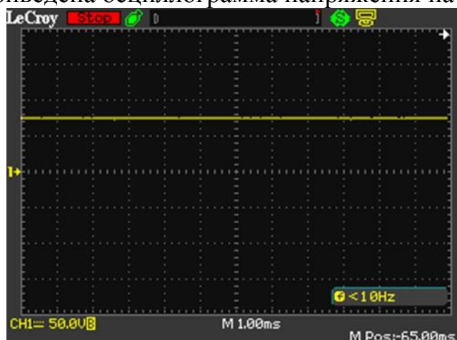
Рис. 1. Напряжение на светодиодах
