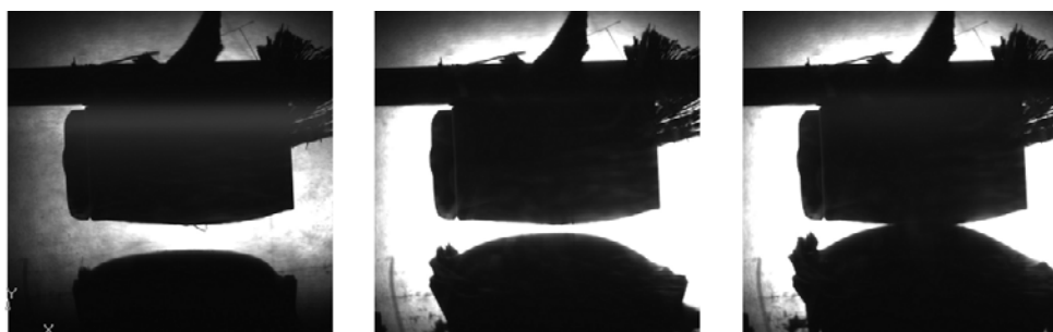
Рис. 2. Кинематика процесса при энергии разряда МИУ 2 кДж
