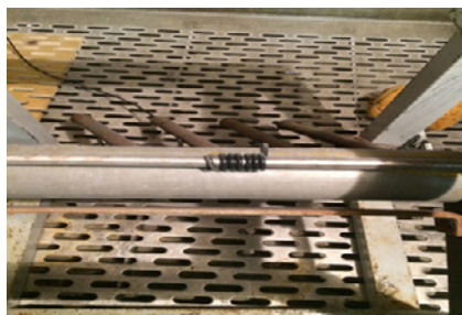
Рис. 1. Образец для испытаний на монтажный изгиб
