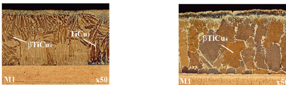
Рис. 5. Структура ЗВ, сформированная после продолжительного отжига и полного растворения титанового слоя при 900 °С
