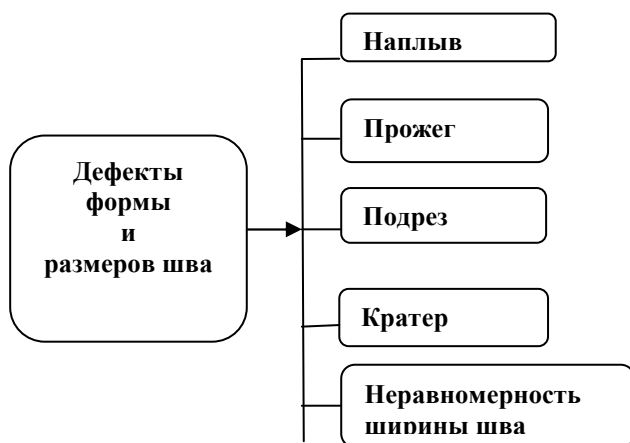
Рис. 1. Дефекты формы и размеров шва внешние
