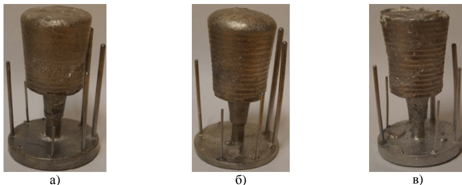
Рис. 2. Внешний вид полученных отливок: а) без МИО; б) с МИО (режим 1); в) с МИО в литейной форме (режим 2)
