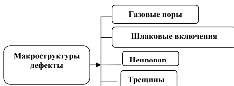
Рис. 2. Дефекты макроструктуры внутренние
