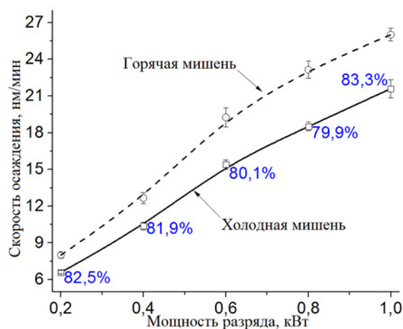
Рис. 2. Зависимость скорости осаждения плёнок никеля от мощности разряда и типа мишени
