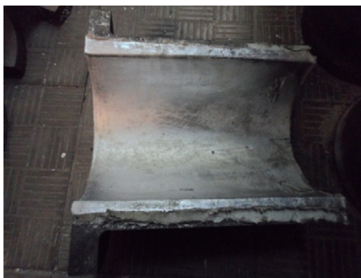
Рис. 2. Вкладыш МОП после заливки баббитом Б-16
