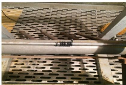
Рис. 1. Образец для испытаний на монтажный изгиб
