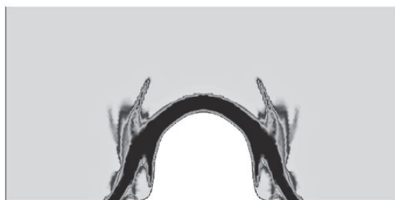
Рис. 4. Топология оптимального укрепления для оптимальной формы свода
