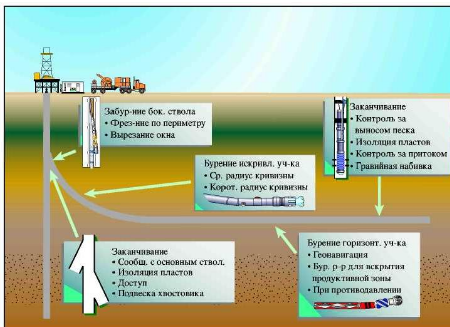
Рис. 1. Система бурения бокового ствола
