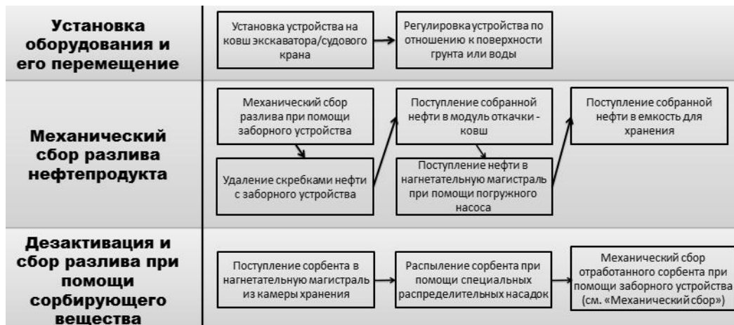
Рис.2 Схема работы универсального многофункционального устройства ЛАРН
