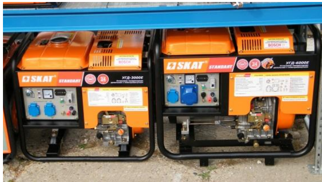
Рис.1. Переносные дизель-генераторы с воздушным охлаждением
