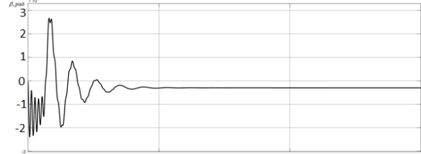
Рис. 5. График переходного процесса угла отклонения от вертикали при нечетком изменении И- составляющей
