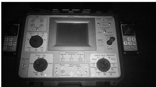
Рис.3. Пульт дистанционного управления для мобильного робототехнического комплекса
