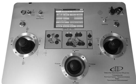
Рис. 4. Модернизированный пульт дистанционного управления для семейства МРК
