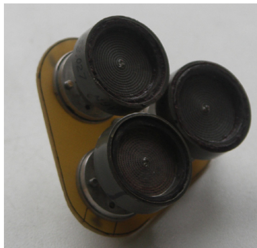
Рис. 2. Внешний вид облучателя трехлучевой параболической антенны
