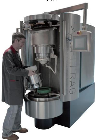
Рис. 2. Фотография установки SelFrag-Lab
