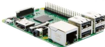
Рис.2. Миникомпьютер Raspberry Pi 2
