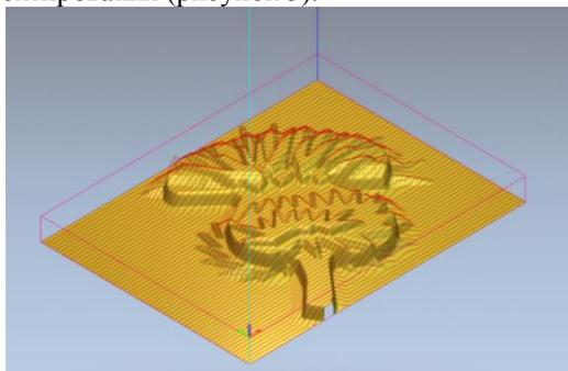
Рис. 5. Симуляция обработки на фрезерно-гравировальном станке.
