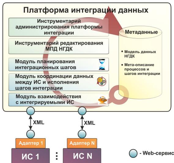
Рис. 2. Обобщенная структура платформы интеграции производственных данных НГДК
