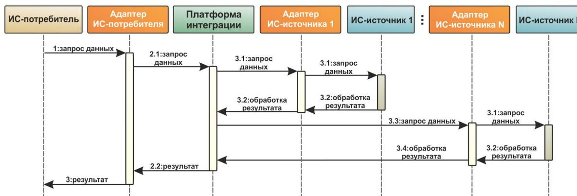
Рис. 3. Диаграмма последовательности выполнения запроса под управлением платформы интеграции производственных данных
