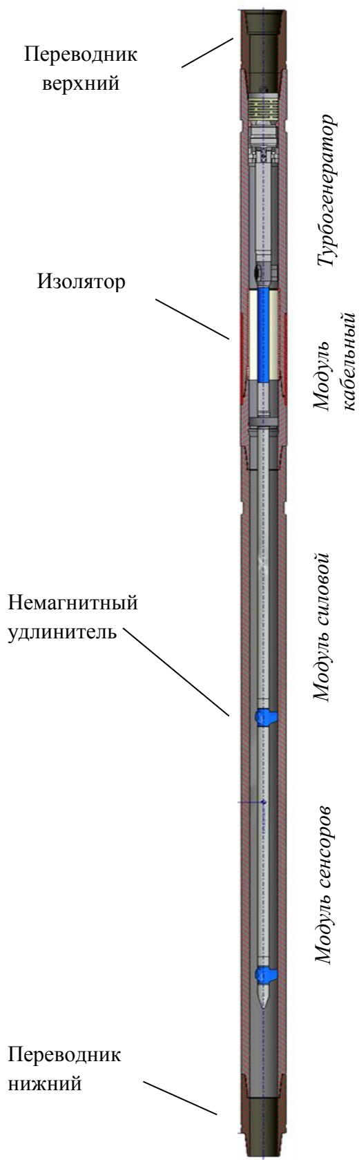
Рисунок 1.12 – Телеметрическая система СИВ-2.2
