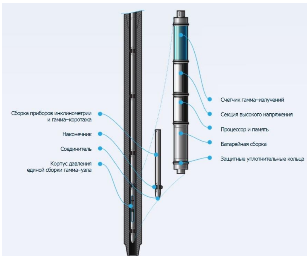
Рисунок 1.16 – Модуль гамма-каротажа компаний «Geolink» и НПП «ГЕРС»
