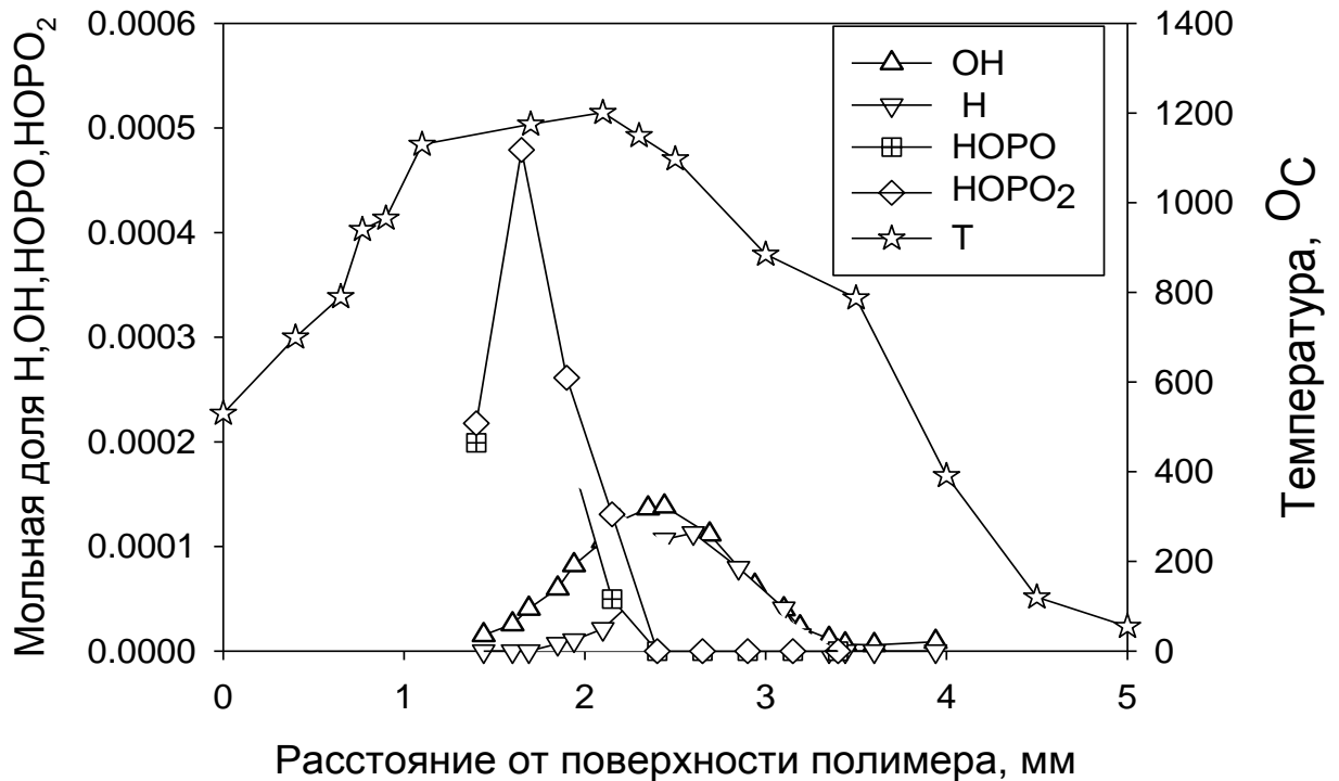
Рисунок 3.37. Профили мольных долей радикалов Н и ОН, а также кислот фосфора НОРО, НОРО 2 в пламени СВМПЭ с добавкой 5 % ТФФ в противотоке воздуха.
