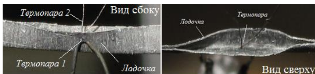
Рисунок 2.16. Расположение термопар на лодке и внутри лодки.
