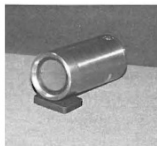
Рисунок 1.1 Блок-схема (а) и фотография (б) воздушного УЗ пьезопреобразователя со сферической фокусировкой
