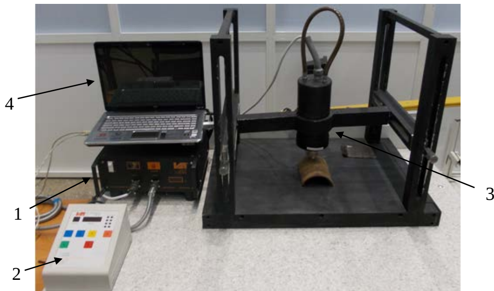
Рисунок 2.4 Лабораторная установка для импульсной генерации акустических волн
