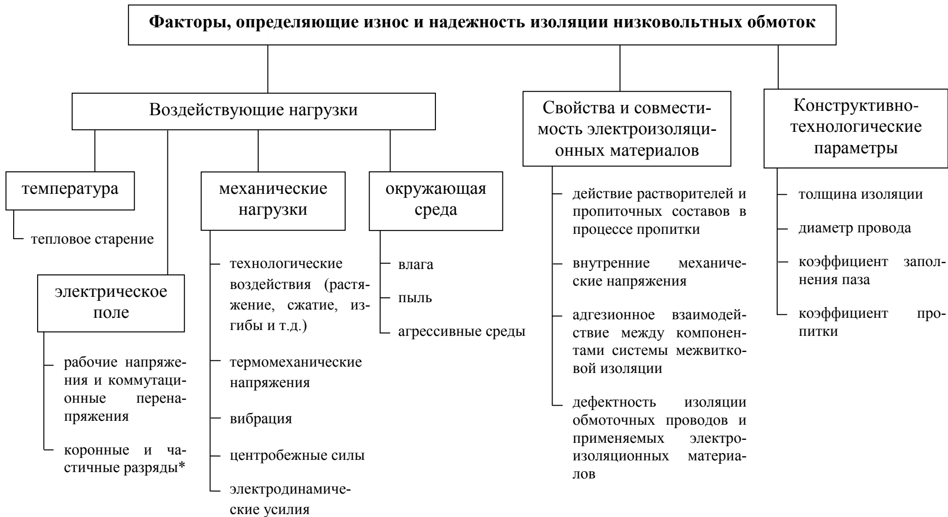
Рисунок 1.3 – Основные нагрузки и факторы, определяющие износ и надежность изоляции обмоток.
