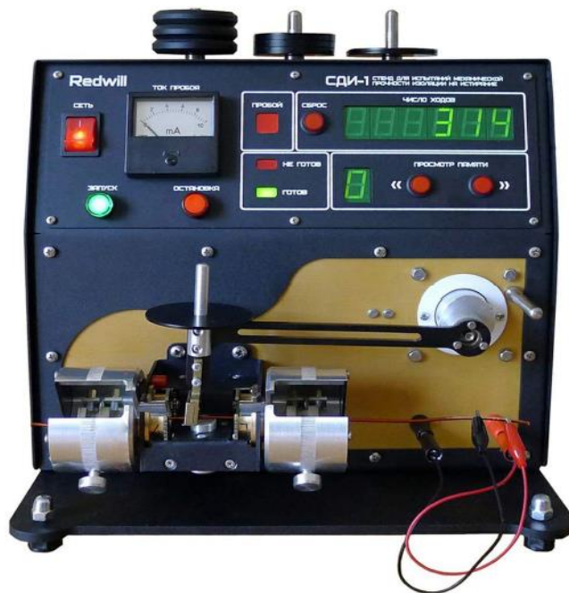
Рисунок 2.1 – Стенд для лабораторных испытаний изоляции обмоточных проводов на стойкость к истиранию.
