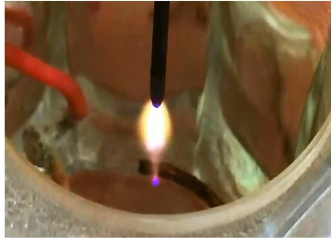
Рисунок 1.1.2 – Тлеющий разряд с одним жидким электродом [39]
