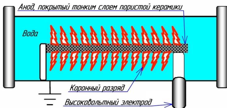
Рисунок 1.3.1 – Реактора обеззараживания воды коронным разрядом [114]
