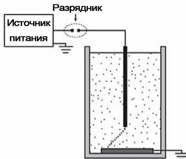
Рисунок 1.4.1 а, б - Подводный искровой разряд (а) и схема технологии его образования (б) [108]
