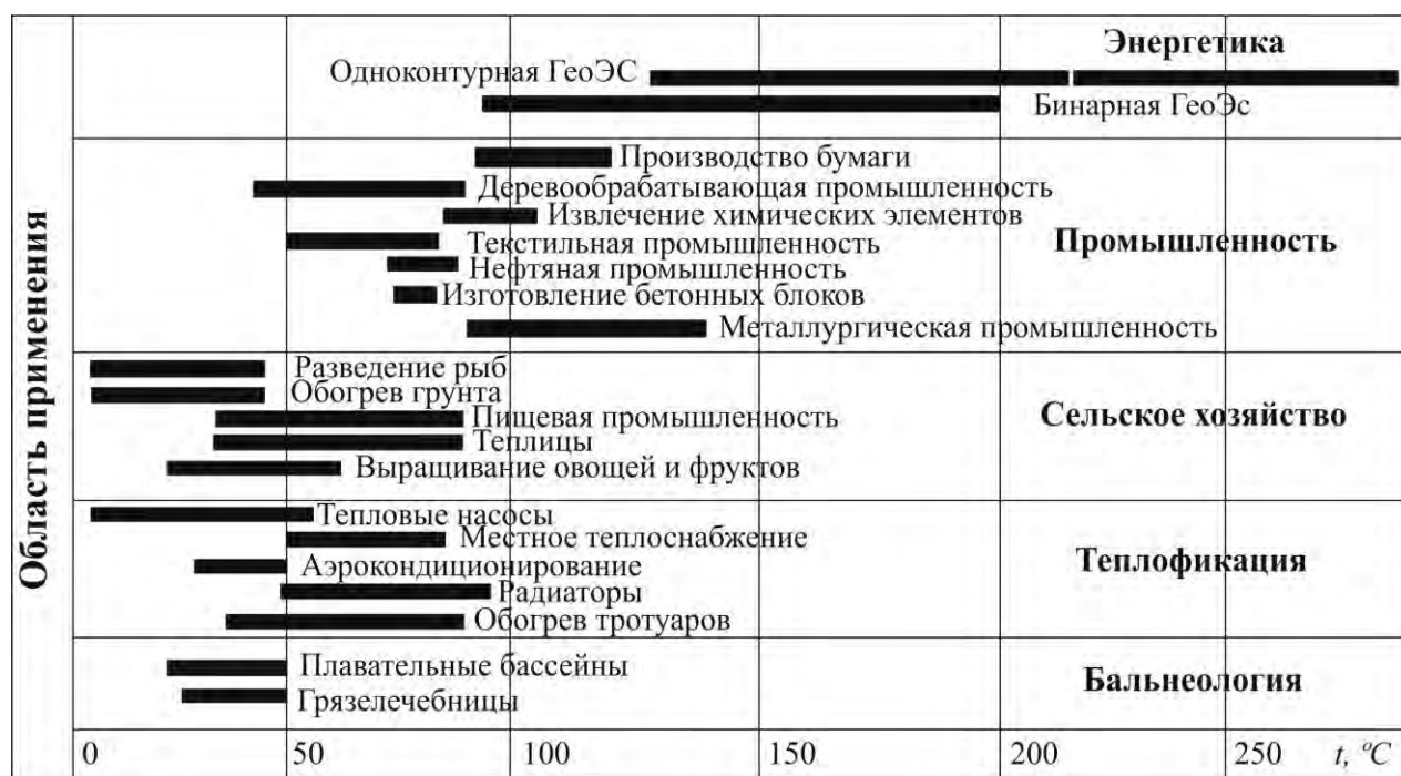
Рисунок 1.1. Диаграмма использования геотермального тепла [Поваров, 2003]
