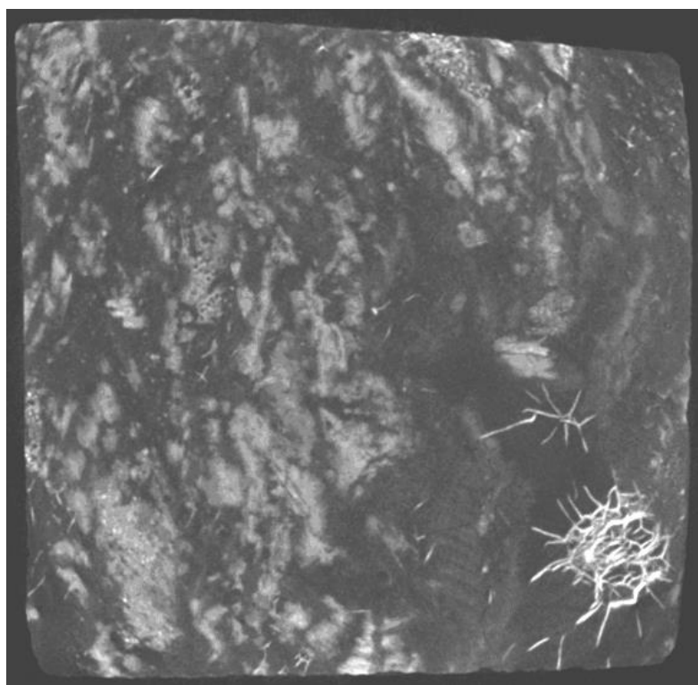
Рис. 4.7. Реконструированные сечения каменного угля с TOLMI-150-10 (а) и GE Phoenix (б)
