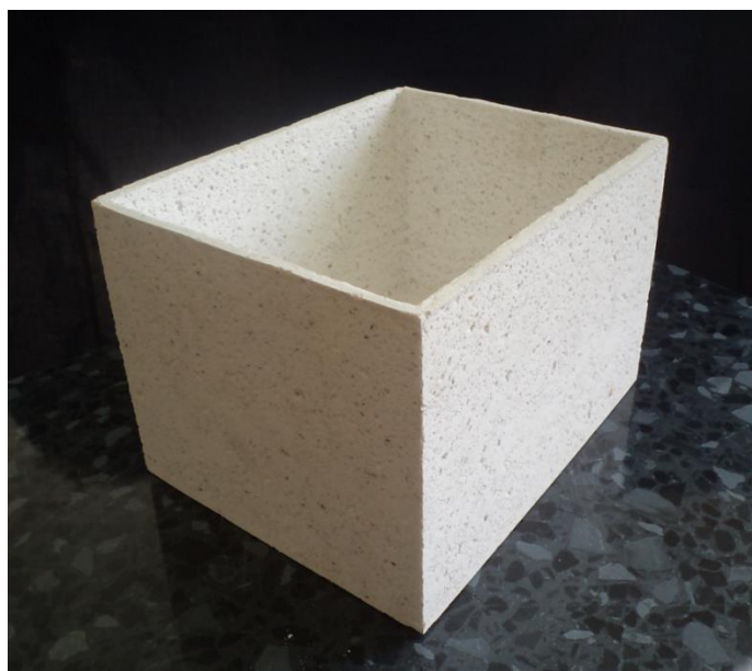
Рисунок 4.7 – Опытный образец-капсель размером 255 x 200 x 165 мм (толщина стенки 7 мм)
