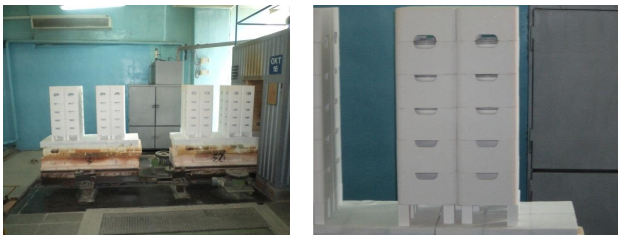
Рисунок 5.5 – Вагонетки печи Wistra 3 с загруженными изделиями
