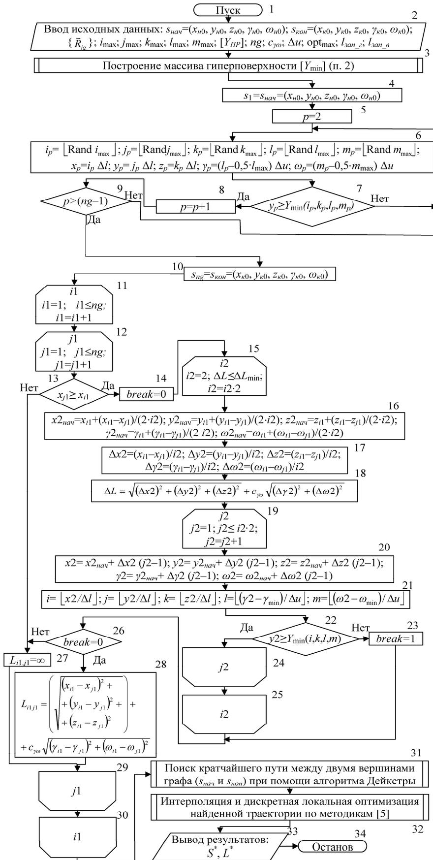
Рис. 2. Блок-схема модифицированного алгоритма ВДК для 5-и учитываемых обобщенных координат груза
