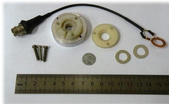
Рисунок 2.3 – Фотографии экспериментального образца акустомонохроматора
