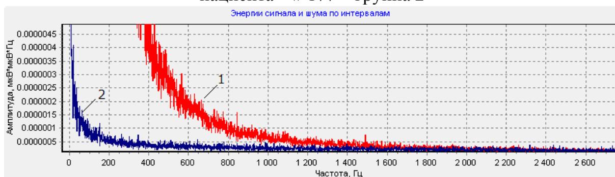
Рисунок 5.4 – Значения энергии электрокардиосигнала и шума АПК при закороченных проводах в узких частотных интервалах (0,8 Гц) пациента # 145 – группа 3
