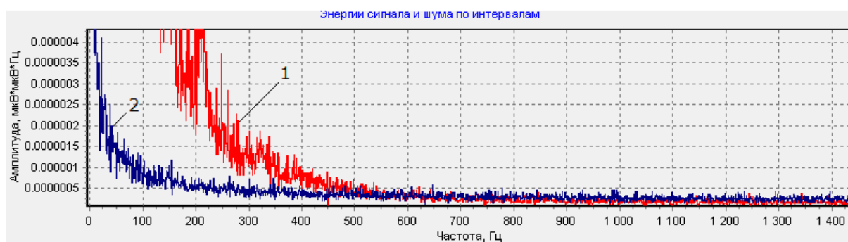
Рисунок 5.1 – Значения энергии электрокардиосигнала и шума АПК при закороченных проводах в узких частотных интервалах (0,8 Гц) пациента # 106 – группа 1А
