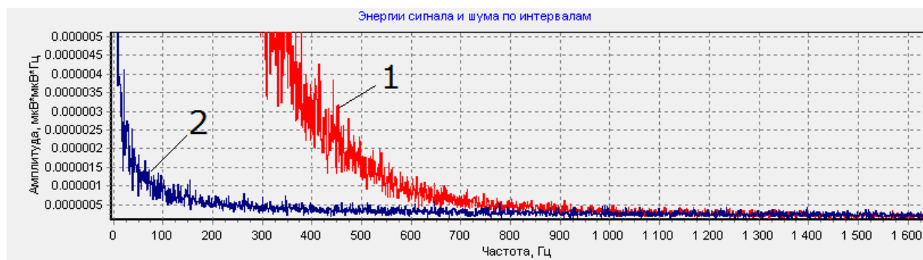
Рисунок 4.2 – Значение энергий электрокардиосигнала и шума АПК при закороченных проводах в узких частотных интервалах (0,8 Гц)
