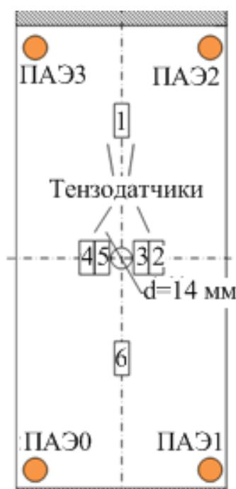
**Рисунок 3.8 –Схема установки ПАЭ и тензодатчиков на образец**
