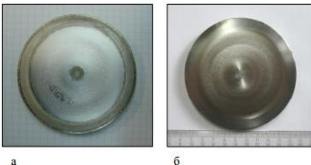
Рисунок 1.4. Фотография изображения (а) мишени титана после РМР в среде  $Ar/N_2$  газов (а) и после процесса магнетронного распыления уже без реактивного газа (б) [87].
