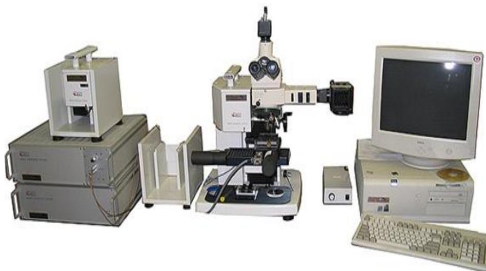
Рисунок 2. 11. Фотография нанотвердомера Nano Hardness Tester NHT- S- AX- 000X.
