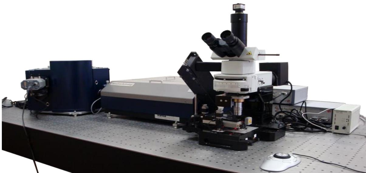
Рисунок 2.3. Фотография установки АСМ/Раман спектрометра Centaur HR.
