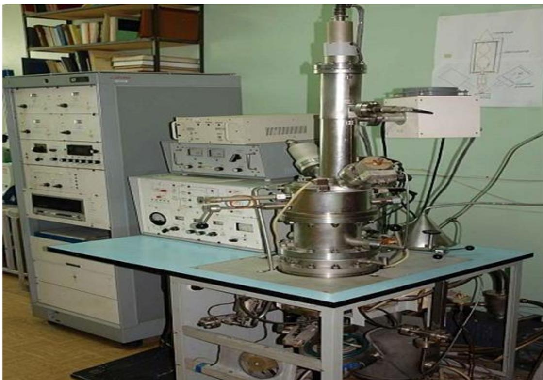
Рисунок 2.6. Фотография установки вторично-ионного масс-спектрометра МС-7201М.
