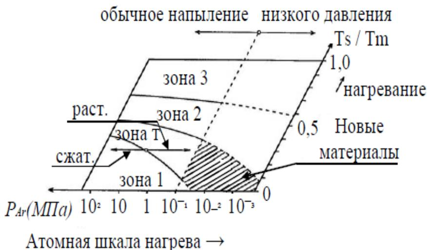
Рисунок 1.12. Структурно-зонная модель Тортона [87].
