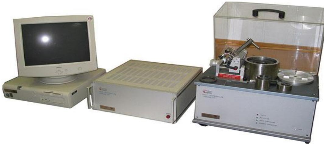
Рисунок 2.10. Фотография прибора PC-Operated High Temperature Tribometer THT-S-AX0000.
