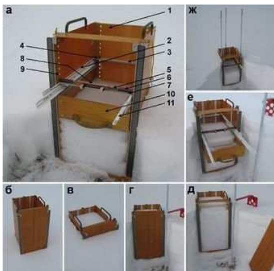
Рисунок. 2.4. Устройство для послойного отбора снега (а) и схема его использования (б-ж). Пояснения в тексте.
