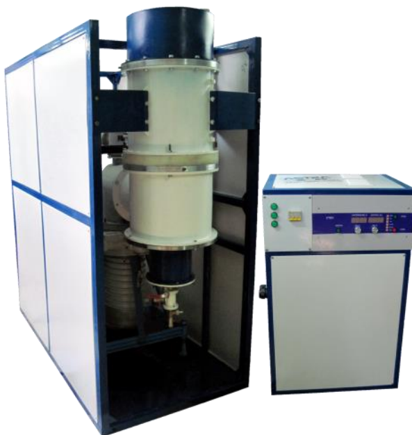
Рисунок 16. Внешний вид частотного импульсного ускорителя электронов «АСТРА» с блоком питания и управления.
