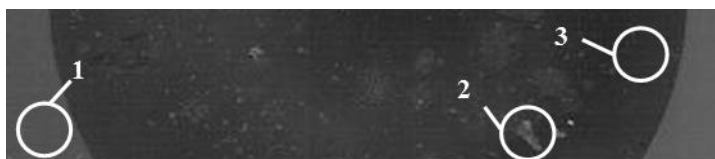
Рисунок 63. Внешний вид разделительной фольги выходного окна без поддерживающей решетки со стороны катода после 10^5 импульсов тока пучка с охлаждением водовоздушной смесью: 1 – область фольги, не подверженной влиянию электронного пучка; 2,3 – области покрытой плёнкой фольги.
