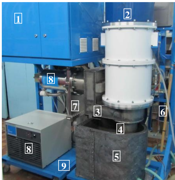
Рисунок 67. Внешний вид импульсного электронного ускорителя «АСТРА-М» со снятой радиационной защитой. 1 – источник первичного электропитания; 2 – генератор высоковольтных импульсов; 3 – вакуумная камера электронного диода; 4 – камера обработки; 5 – местная радиационная защита; 6 – система регенерации и охлаждения трансформаторного масла; 7 – высоковакуумный затвор; 8 – высоковакуумный крионасос; 9 – станина.
