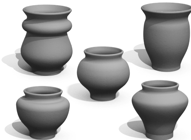
Рис. 5. Варианты моделей из серии с отклонениями параметров, превышающими порог в 10...15 %. Исходная модель в центре
