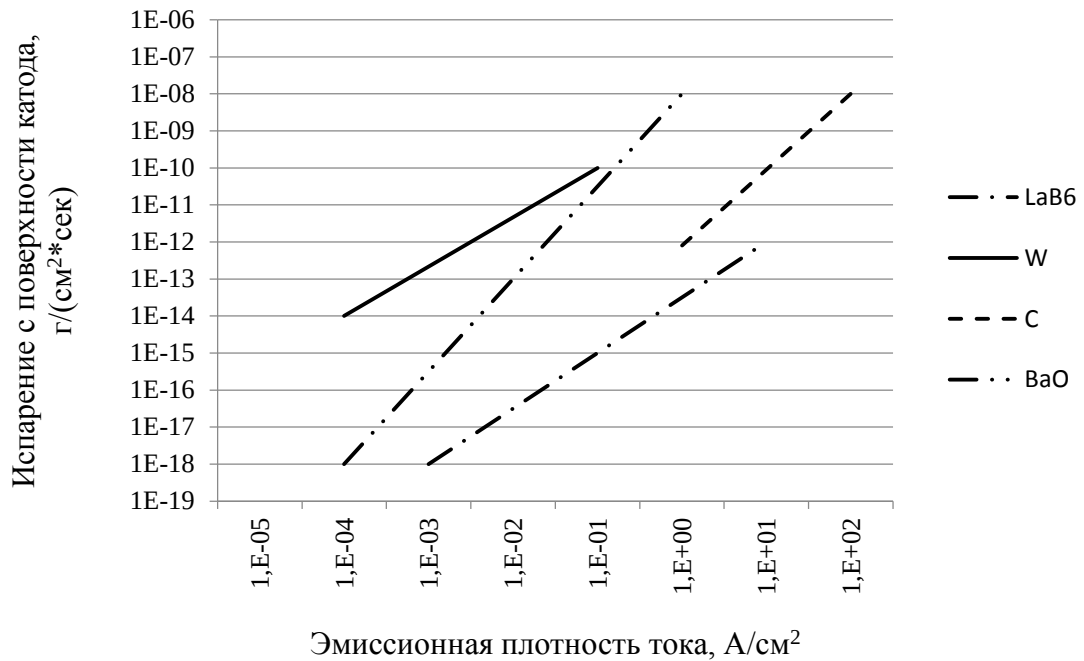
Рисунок 4.6 Испарение материала с поверхности катода в зависимости от эмиссионной плотности тока
