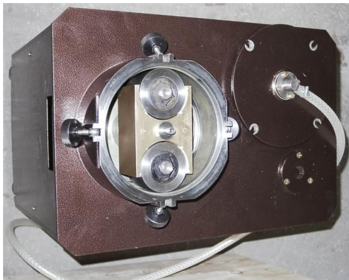
Рисунок 2.3 Общий вид активатора планетарного типа АГО-2С
