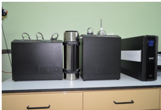
Рисунок 2.9 Прибор для измерения удельной поверхности дисперсных и пористых материалов серии СОРБИ-М
