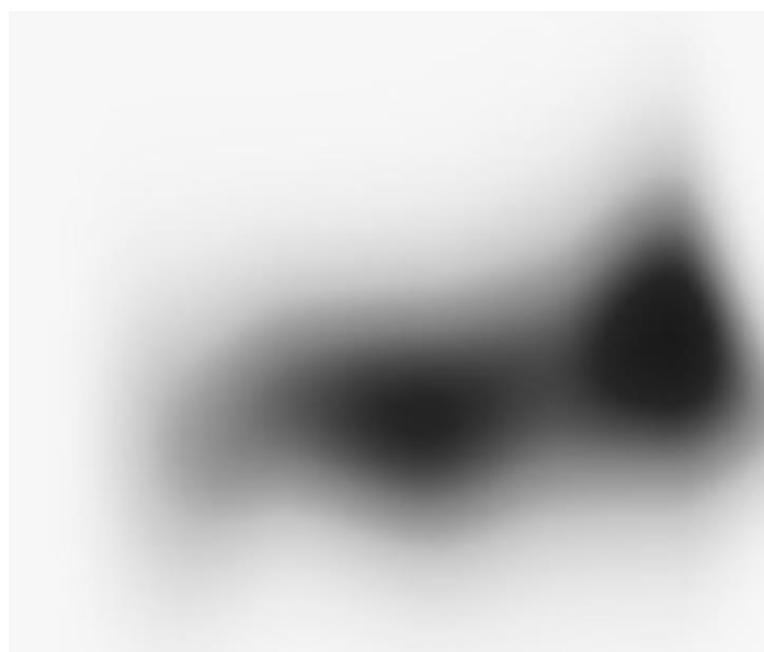
Рисунок 4.5 След пучка электронов при использовании односоставного катода
