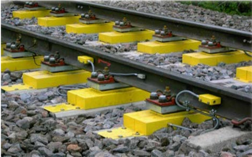
Рисунок 1.11 – Фотография диагностического оборудования системы Multirail WheelScan [122]
