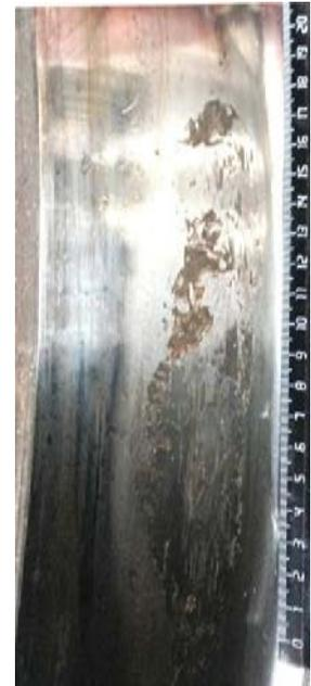
Рисунок 4.20 – Тензометрические сигналы и фотография ползуна с выщербинами на 19-м колесе
