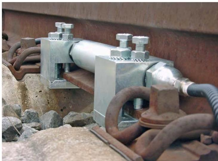
Рисунок 1.8 – Фотография лазерного датчика измерительной системы Lasca [115]
