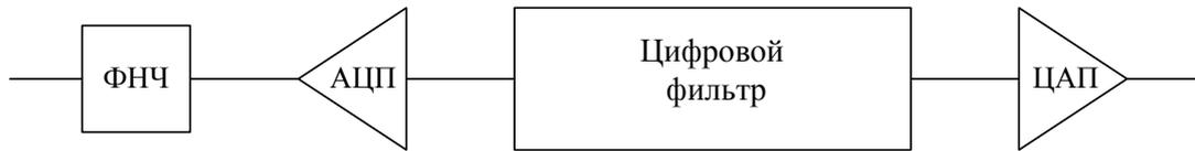
Рисунок 1.18 – Схема фильтрации аналогового сигнала
