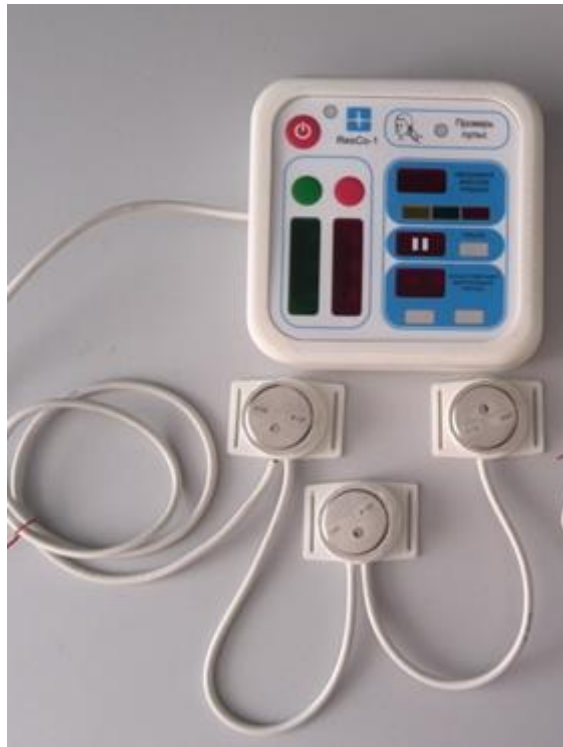
Рисунок 3.1 – аппаратная часть экспериментального образца Устройства для контроля процедуры сердечно-легочной реанимации человека
