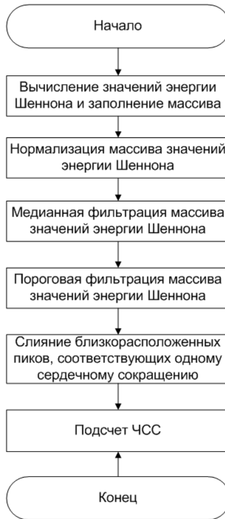
Рисунок 2.17 – принципиальная схема алгоритма определения частоты сердцебиения.
