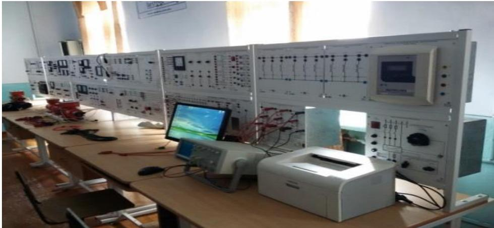
Рисунок 5.6 – Микромодель электрической системы с использованием STATCOM
