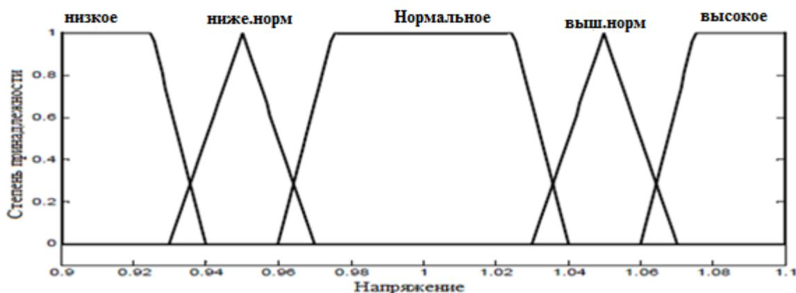
Рисунок 5.3 – Функция принадлежности для напряжения в узлах
