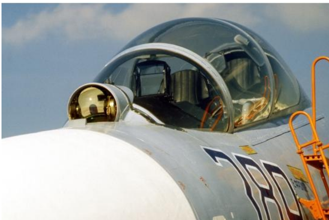
Рис. 1.2. Оптико-локационная станция ОЛС-27 на самолёте Су-27УБ. Сквозь стекло блистера видно зеркало прицельной системы
