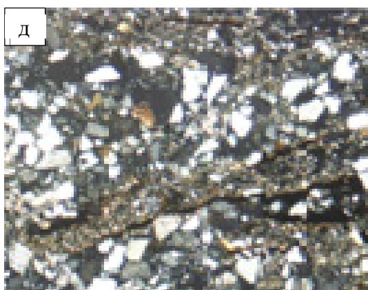
Песчаник мелкозернистый, алевритовый, мезомиктовый, кварцевый с глинистым цементом. Вид: д – при скрещенных николях, е - в проходящем свете, увеличение 40х. Глубина 929,30 м. ПК 1-3 .
