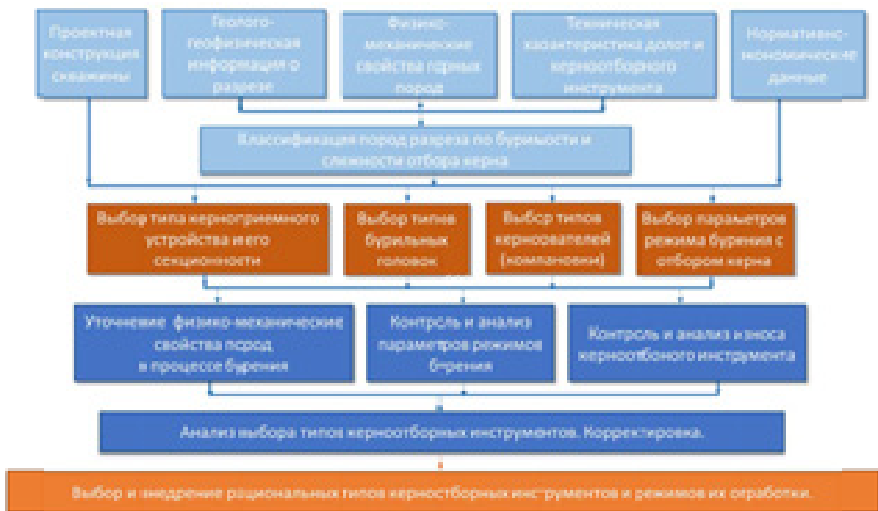
Рисунок 1.2 – Схема выбора рациональных типов кернаотборных инструментов
