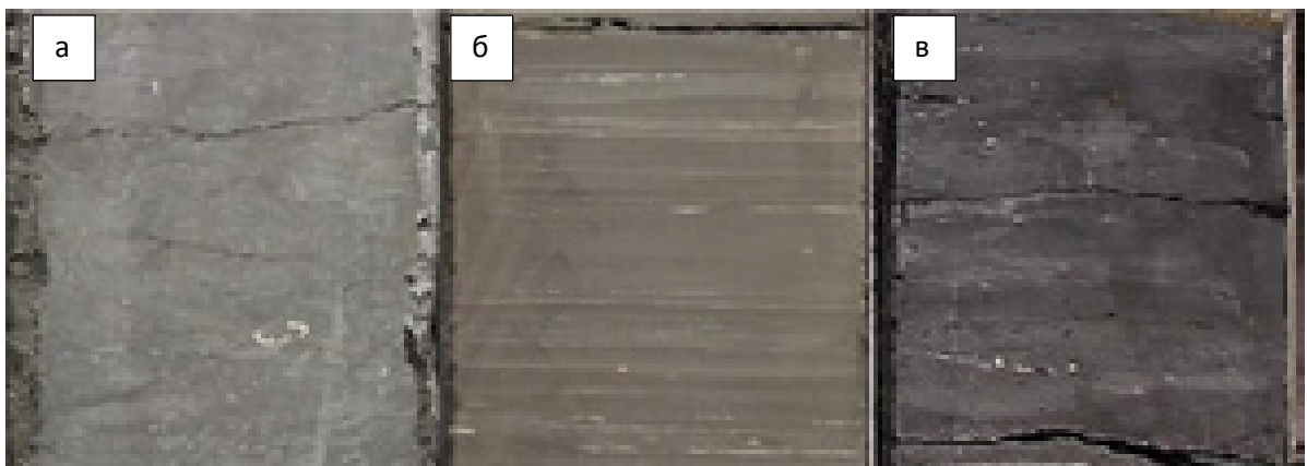
Массивные глины со следами биотурбаций, с линзовидной, линзовидно-волнистой слоистостью: а-в - ширина изображения 100 мм. Глубина 805,5 м. Пласт ПК 1-3 .
