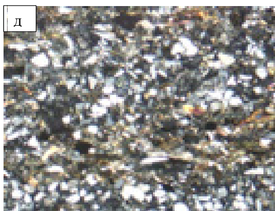
Алевролит песчаный, с глинистым цементом, микролинзовиднослоистый. Вид: д – при скрещенных николях, е – в проходящем свете, увеличение 40х. Глубина – 898,00 м.
