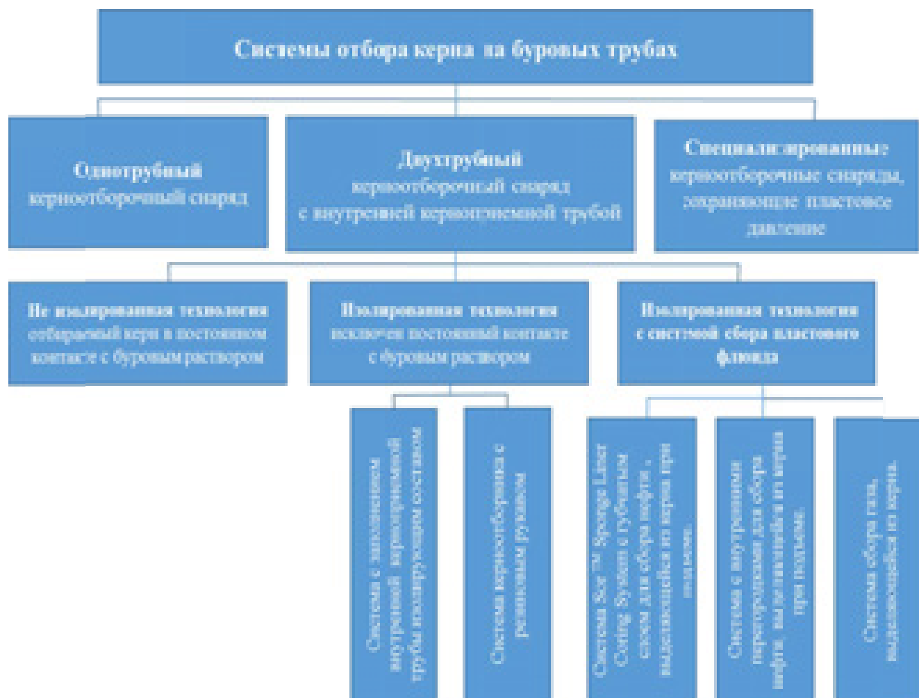
Рисунок 1.1 – Системы отбора керна на буровых трубах
