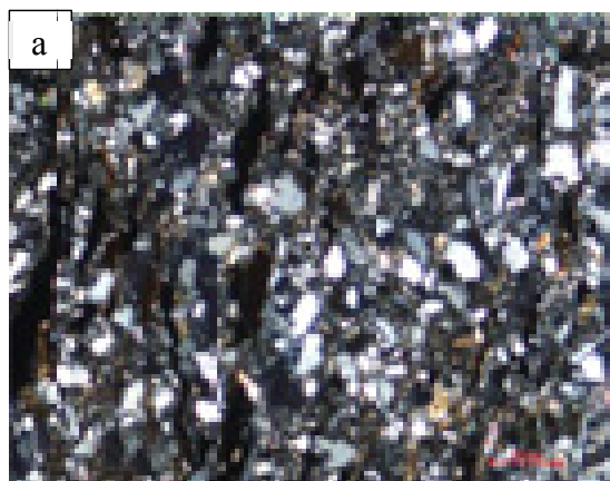
Алеврит крупнозернистый линзовидно-слоистый с глинисто-карбонатным цементом. Вид: а – при скрещенных николях, б – в проходящем свете, увеличение 100х. Глубина 863,81 м. Пласт ПК 1-3.
