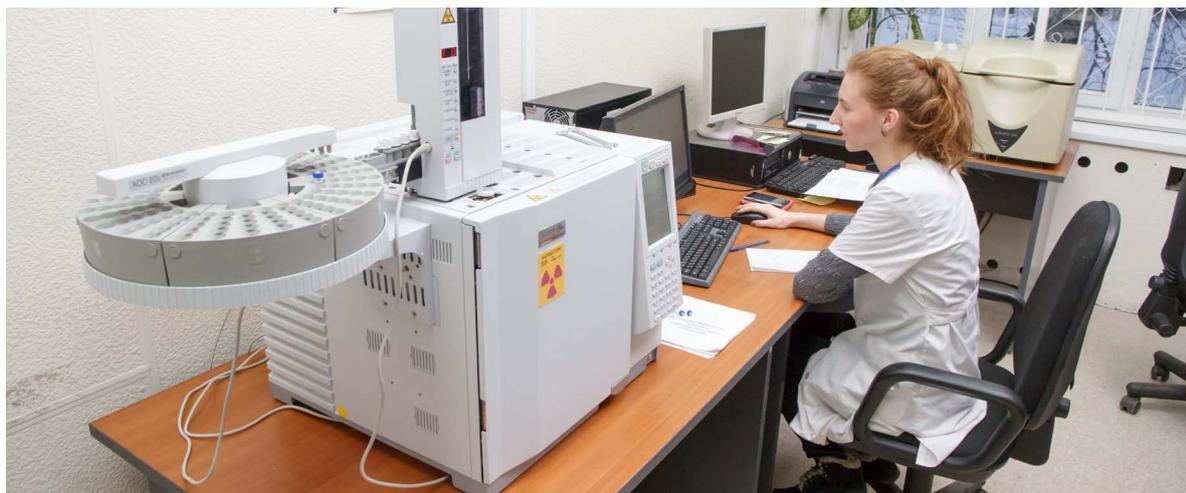
*Газовый хроматограф Shimadzu GC 2010*
