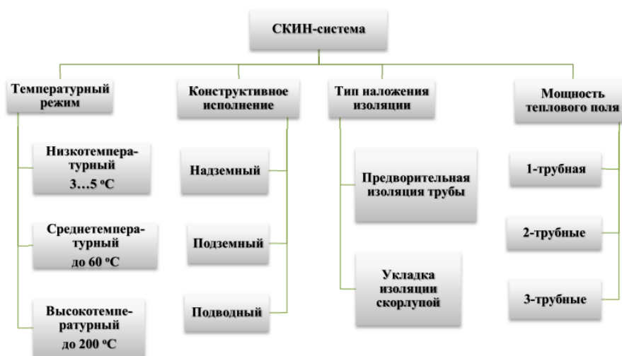
Рисунок 5 – Структурная схема исполнения скин-систем
