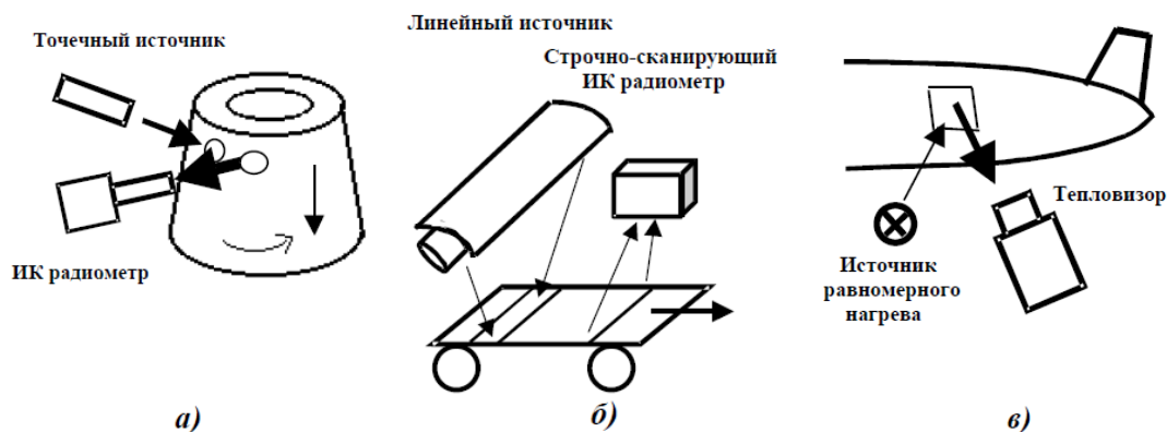
Рисунок 3.1 – Процедуры ТК в зависимости от вида зоны контроля и нагрева, а – поточечное сканирование; б – строчное сканирование; в – тепловизионный способ
