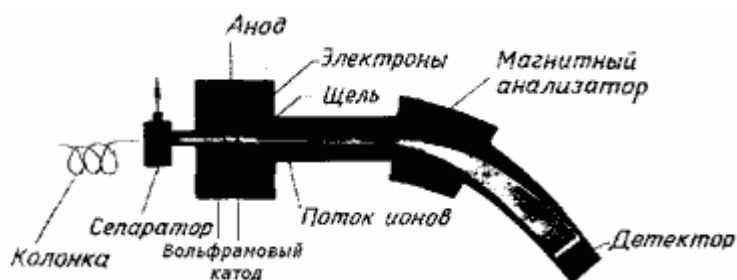
Рисунок 7. Принципиальная схема магнитного масс-спектрометра в комбинации с газовым хроматографом.
