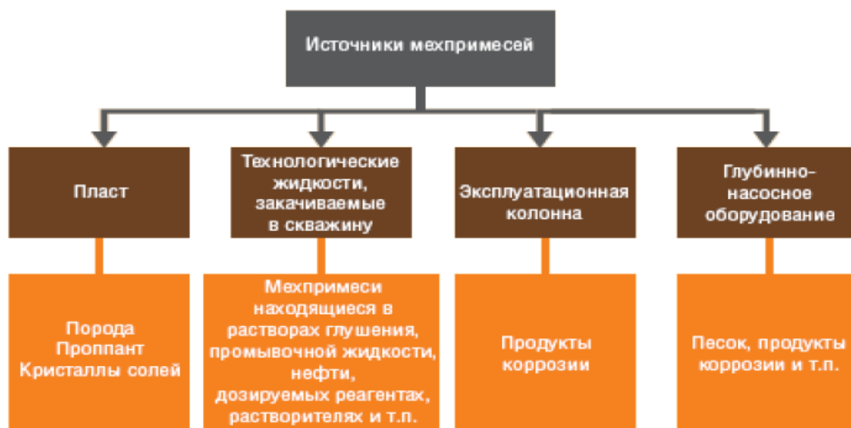
Рисунок 6 - Источники механических примесей, попадающих в насосную установку
