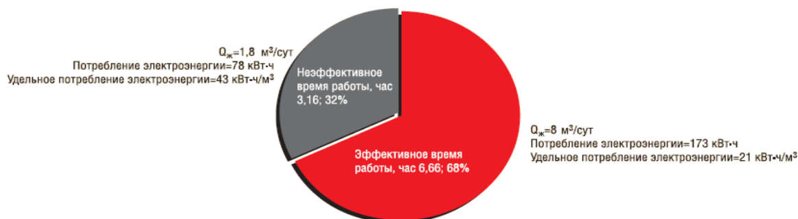
Рисунок 3 – Эффективное и неэффективное время работы установки электрического центробежного насоса
