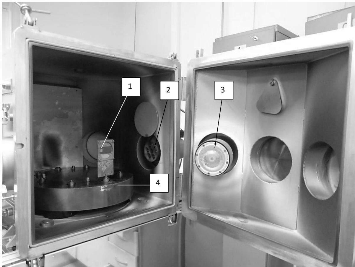
Рисунок 9 – Фотография внутреннего устройства вакуумной камеры установки ионно-плазменного осаждения покрытий: 1 – крепёж для образцов, 2 – ионный источник, 3 – планарный магнетрон с кремниевой мишенью, 4 – вращающийся столик
