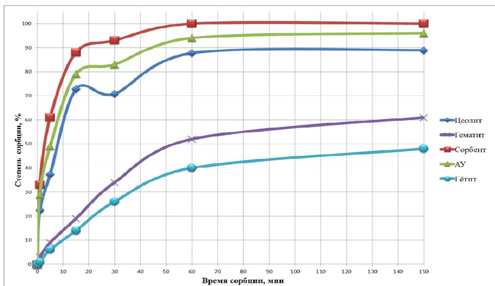
Рисунок 1. Извлечение ионов  $Cd^{2+}$  из водного раствора
