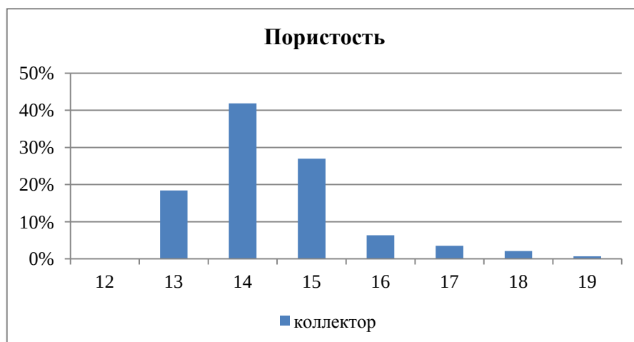
Рисунок 2.2 – Распределение открытой пористости по коллекторам для пласта Ю 1 1 по скважинам 185 и 342
