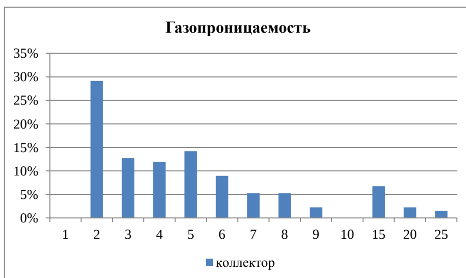
Рисунок 2.3 – Распределение газопроницаемости по коллекторам для пласта Ю 1 1 по скважинам 185 и 342
