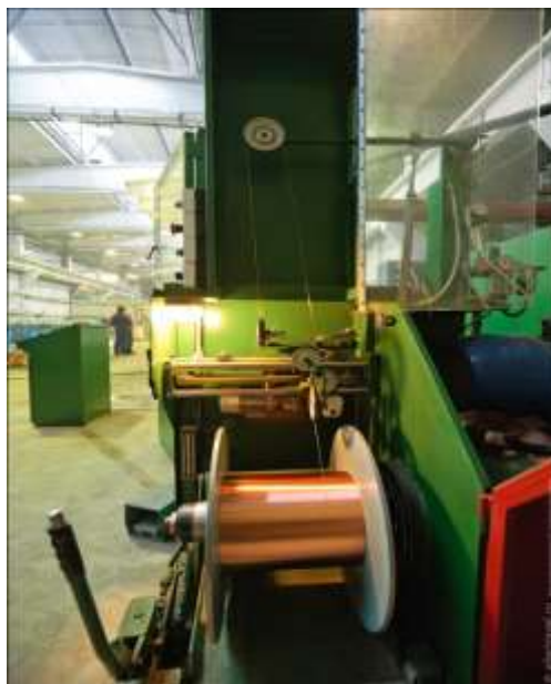
Рисунок 5 – Механизм намотки пасьмы на технологическую тару
