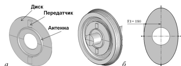
Рис. 4. Внешний вид дисков: а) съёмный диск с измерительным оборудованием и место его установки; б) полученная форма диска в плане
